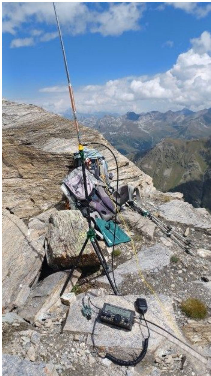
HB9NBG+HB9FZCs SOTA-Erfolgssetup: ELECRAFT KX2 mit AX1/AXE1-Teleskopantenne auf Cleverstick SOTA – 'Wanderstock-Stativ' und Original-Mik für SSB, sowie BaMaKey TP-III Taste für CW-Betrieb
