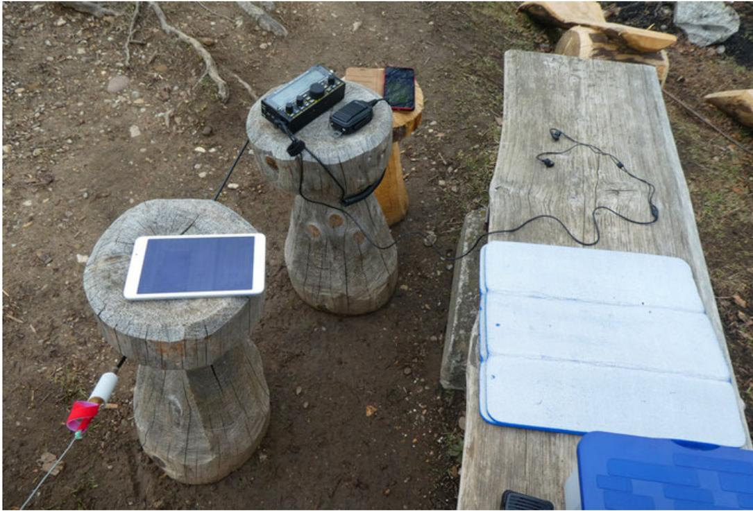
Auslegeordnung für den SOTA-Einsatz auf der Wilkethöchi: KX2 mit Handmikrofon, Mobiltelefon, Ohrstöpsel, Tablet fürs Logbuch, Ende des Antennendrahts mit 1:64-Koppler, Koaxialkabel und Sitzpolster für den Operator. Die Schnitzerarbeiten am Summit sind für mich nützlicher Luxus.
