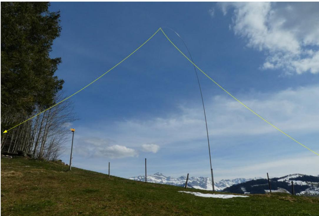
Standard-Aufhängung für die Endfed. Als Haltepunkt für den 10-m-Mast dient ein Zaunpfosten. Für das entfernte Drahtende habe ich einen «Zwickdraht»-Halter zweckentfremdet.
