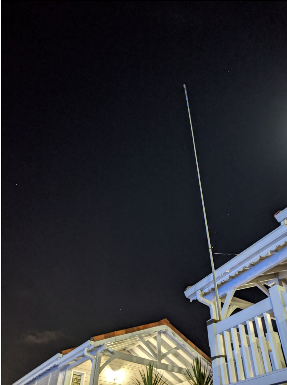
Vertikal-EFHW in der Hotelanlage mit erhöhtem Störpegel
