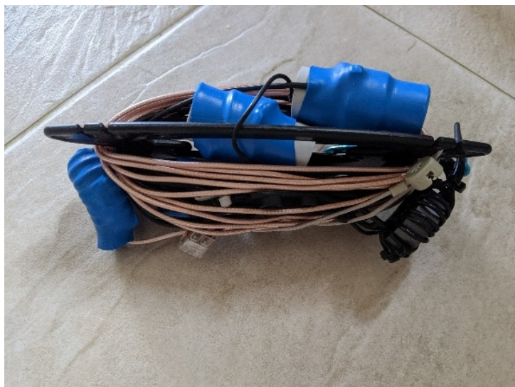
flach strahlende 4-Band vertikal-EFHW mit Coax-Traps, Balun und Mantelwellensperre
