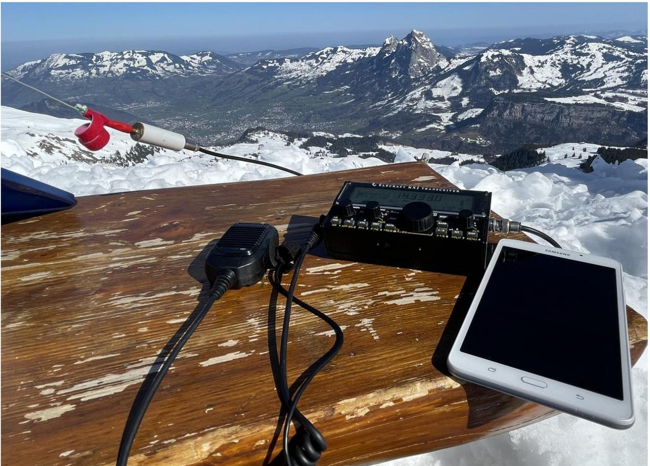
*Keine Ausfälle während des Jubiläumsjahrs! Mit der Standard-Ausrüstung lief es während des ganzen Jubiläumsjahrs super: KX2 mit 10 Watt, Endfed mit Koppler 1:64, Handmikro und Ohrstöpsel, Mini-Tablet mit VK port-a-log fürs Logbuch. Hier am Chlingenstock, HB/SZ-017, mit Blick in den Schwyzer Talkessel.*
