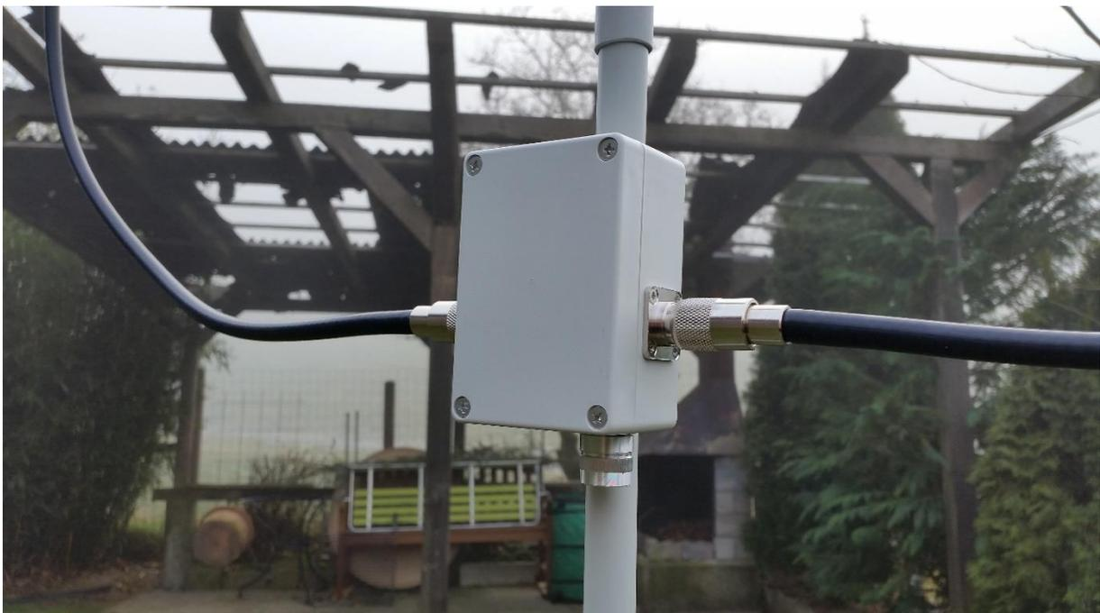
*Am Knopf unten lässt sich nun die Antenne auf die gewünschte QRG einstellen. Die Antenne lässt sich nach Gehör tunen. Beim lautesten Pegel ist auch das SWR am besten. Der Drehkondensator reicht durchgehend vom 40m bis 10m Band.*
