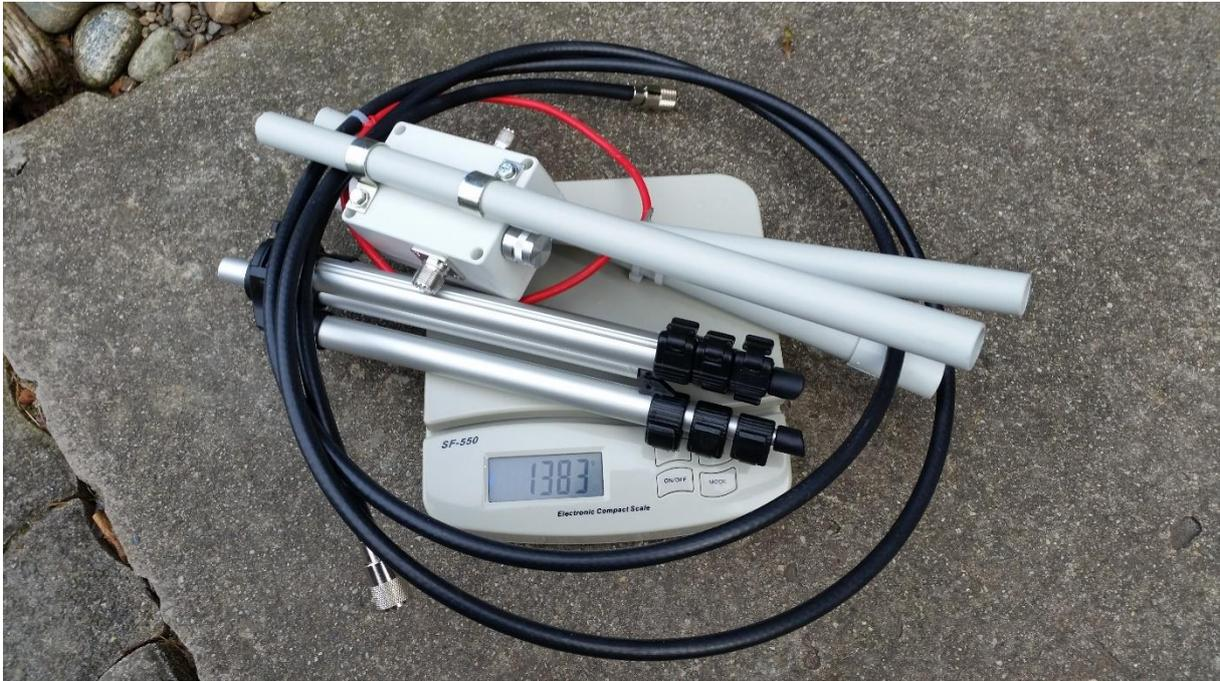
*Die Antenne wiegt etwas weniger als 1,4kg und ist in weniger als 60 Sekunden aufgebaut.*
