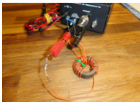
Versuchsaufbau - Messresultate gelbe Linie Rant = 3K3 Ccomp = 80pF
