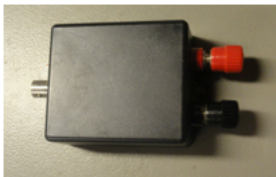
Trafo in Box eingebaut, das „kalte“ Ende auch herausgeführt erleichtert z.B. einen Testwiderstand anzuschliessen
