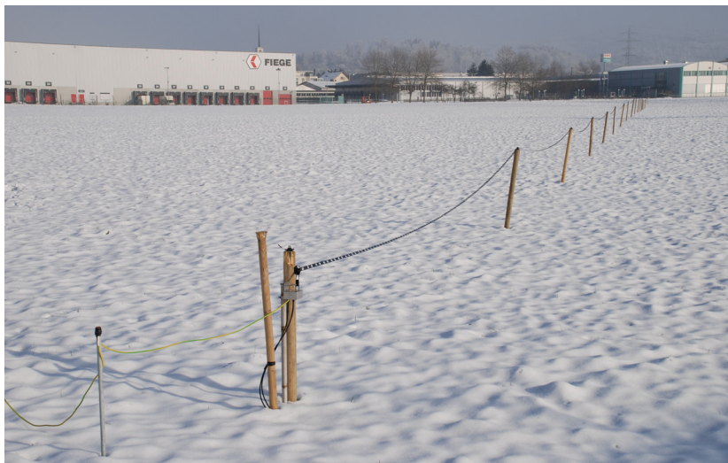
Umschaltbare Beverage-Antenne für USA und Japan
